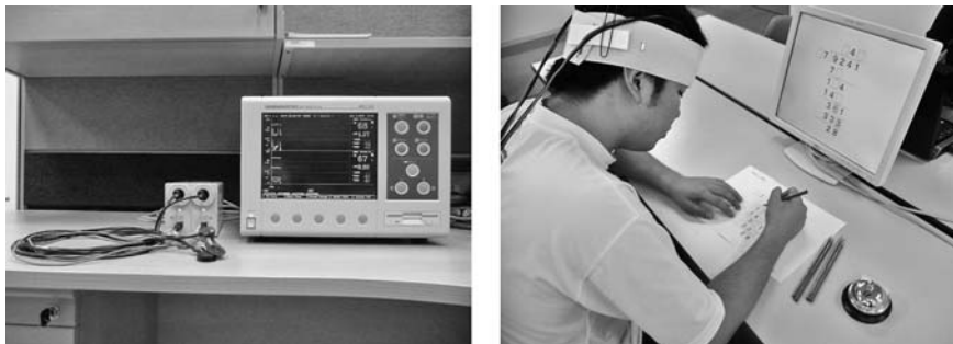
図2 脳活動計測装置 (左：NIRO-200（浜松ホトニクス）、右：実験状況）
